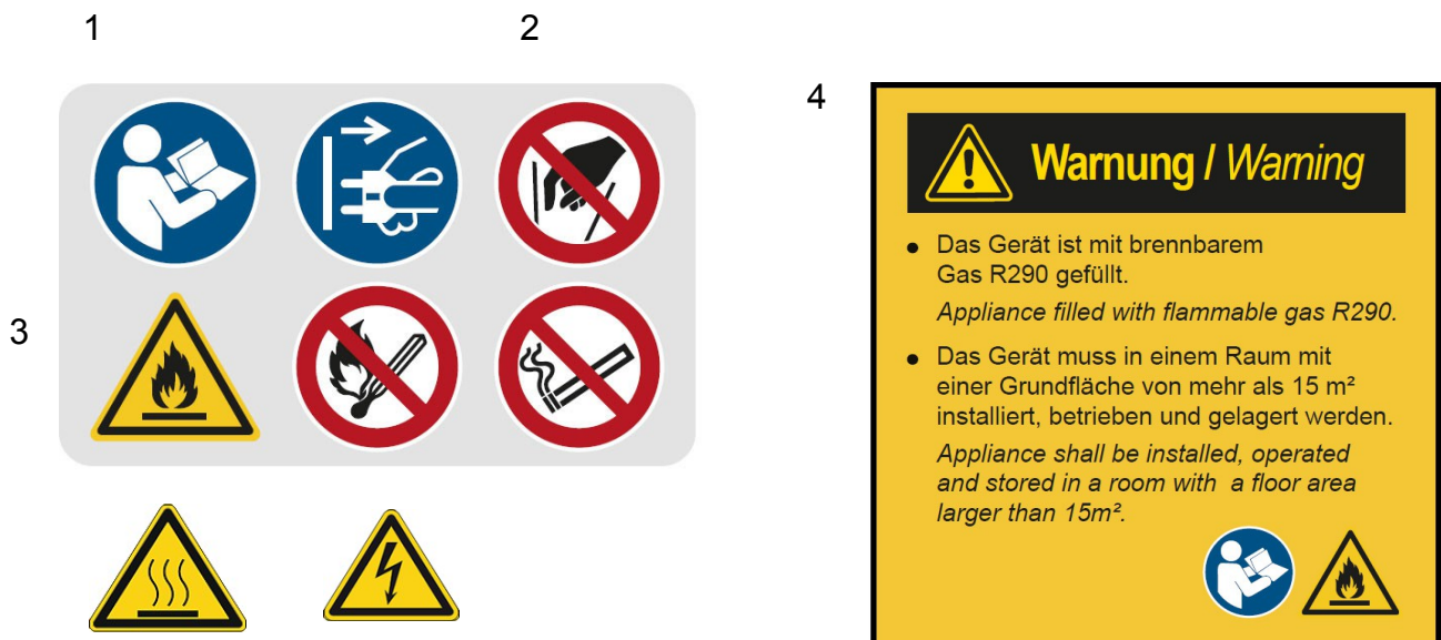
Bild 1-1: Säkerhetsmärkning: 1 Skylt med obligatoriskt märke: Beakta bruksanvisningen, dra ut nätkontakten I 2 Förbudsskylt: Rör inte, inga öppna lågor, eld, rökning förbjuden 3 Varningsskyltar: Varning för brandfarliga ämnen, Varning för het yta, Varning för elektrisk spänning 4 Varning
