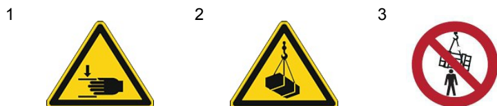
Fig.1-1: Säkerhetsmarkeringar - 1 Klämrisk | 2 Varning för hängande last | 3 Förbud mot att stå under hängande last
